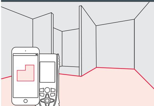
I Leica DISTO™ X3 e X4 abbinati all'applicazione DISTO™ Plan, garantiscono una maggior efficienza. Grazie a nuove tecnologie questi strumenti sono in grado di memorizzare contemporaneamente le distanze e l'angolo tra due delle misure rilevate. L'applicazione utilizza quindi le informazioni per generare planimetrie esatte nel tablet o nello smartphone.
