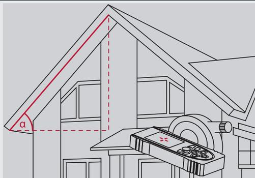
Questa tecnologia permette di misurare in modo rapido e semplice la distanza tra due punti qualsiasi, senza spostarsi dalla posizione in cui ci si trova. Questo grazie ai nuovi sensori installati nel Leica DST 360 e nella Smart Base del Leica DISTO™ S910 che utilizzano le informazioni sugli angoli.
